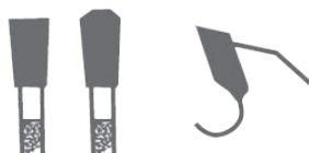
Dientes TCG plano trapecoidal corte de aluminio y metal
