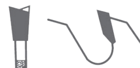
Dientes ATB bisel superior alterno
